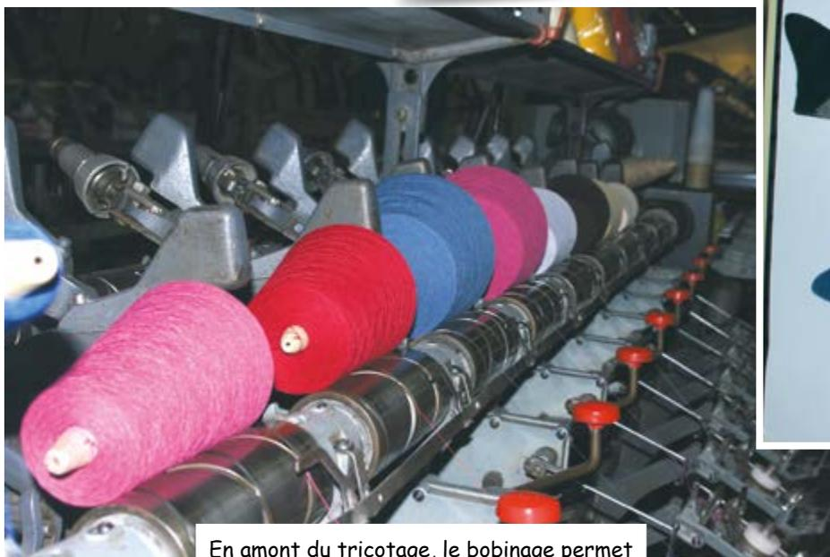
En amont du tricotage, le bobinage permet d'obtenir un volume de fil considérable.
